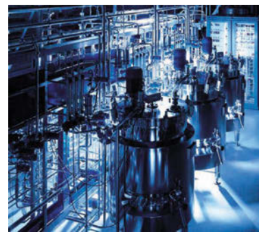
Figura 4-50 Companhias de biotecnologia produzem grandes quantidades de proteínas de aplicação prática. Na fotografia, é mostrado um fermentador utilizado para o crescimento de células necessárias para a produção de proteínas em larga escala. (Cortesia de Bioengineering AG, Suíça.)
