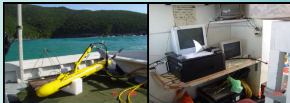
Sistema de Sonar de Varredura Lateral (100/500 kHz)
