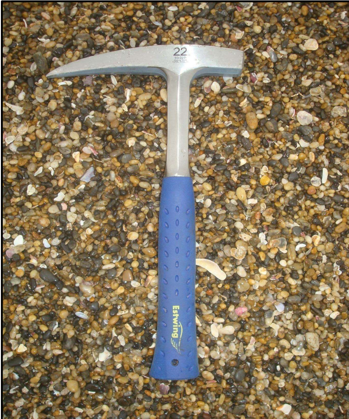
Sedimentos cascalho arenosos do setor de pós-praia da praia do Horta, litoral Centro-norte de Santa Catarina, Brasil, observando-se o moderado selecionamento e subarredondamento dos grãos de diversas fontes minerais (Foto de Norberto Olmiro Horn Filho, outubro de 2014).
