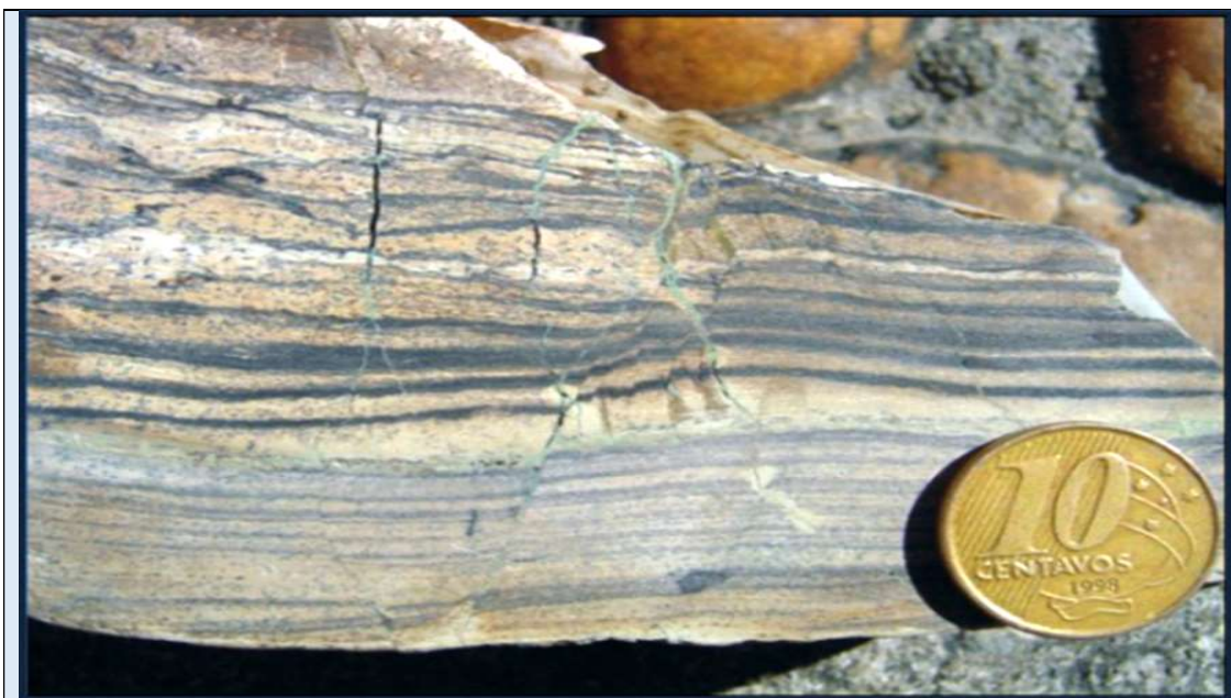
Figura 115. Aspecto macroscópico do fosforito areno-pelítico rico em fosfato sedimentar e óxidos de manganês, um precipitado fosfático primário originado na plataforma continental de baixa energia.
