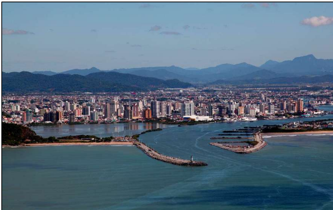
Figura 72. Vista para oeste da desembocadura do rio Itajaí-Açú no oceano Atlântico, onde pode ser observado dois molhes transversais à linha de costa atual construído com fragmentos de rocha do embasamento e representando o Depósito tecnogênico espólio do Holoceno (Recente). A planície costeira do município de Itajaí à retaguarda da foz encontra-se totalmente urbanizada ( www.cidadesemfotos.blogspot.com ).
