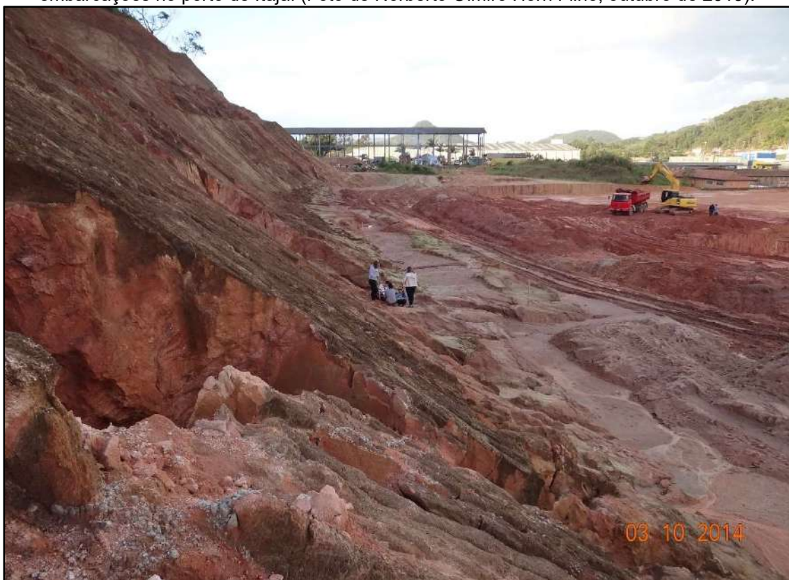
Foto 46. Exploração de sedimentos de uma saibreira em Depósito coluvial do Quaternário indiferenciado, na planície costeira da ilha de São Francisco do Sul, município de São Francisco do Sul (Foto de Norberto Olmiro Horn Filho, outubro de 2014).
