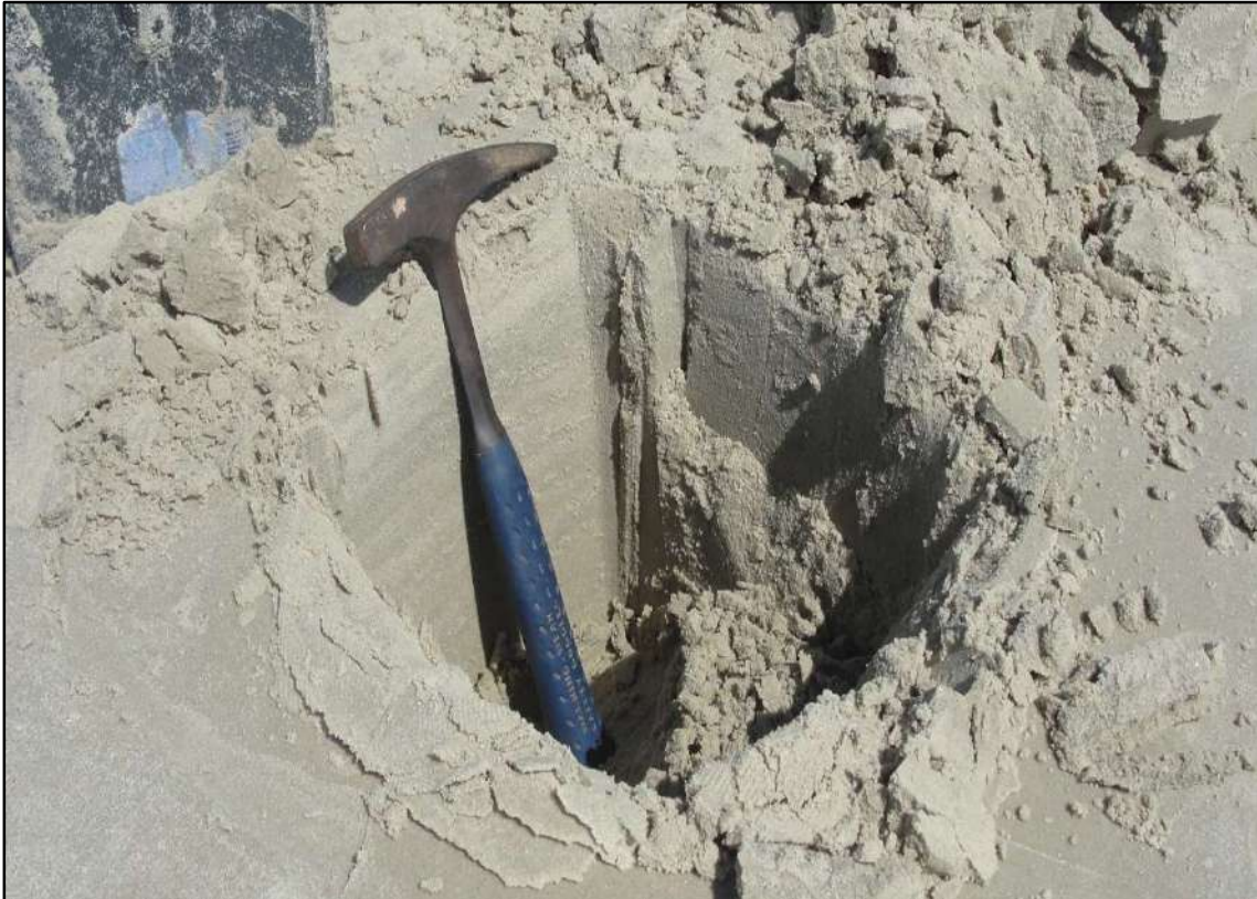
Foto 65. Detalhe da coleta de sedimento do Depósito marinho praiado do setor de pós-praia da praia da Barra da Lagoa, município de Florianópolis, mostrando típico sedimento arenoso fino e estratificado (Foto de Norberto Olmiro Horn Filho, abril de 2011).
